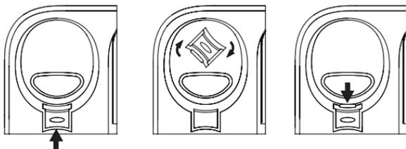
3. Drücken Sie die Laschen wie durch die Pfeile gezeigt zusammen, um die Scharnierklammern zu öffnen. Verlegen Sie das Telefonkabel und das Netzteilkabel durch das Loch der Wandhalterung. Stecken Sie das Ende des Telefonkabels in die Telefonbuchse und den Stecker des Netzteils in die Netzteilbuchse an der Unterseite des Telefons.
