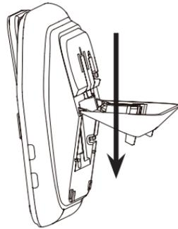
4. Klappen Sie die Wandhalterung herunter und verriegeln Sie sie in dieser Position. Verlegen Sie das Telefonkabel und Netzteilkabel durch den Schlitz an der Unterseite des Telefons. Bündeln Sie das Telefonkabel und das Netzteilkabel ggf. mit Kabelbindern o. ä.
