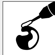
4. Rohling mit speziellen Fräsern ausarbeiten.
